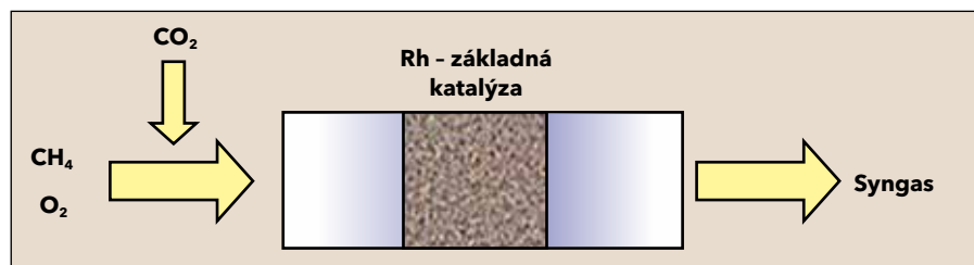
Obrázok č. 1: Princíp konverzie CO 2 na syngas v metanovej katalytickej čiastočnej oxidácii
